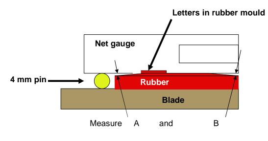
A = B, max 0,2 mm OK A > B, OK A < B > 0,2 mm NOT OK
